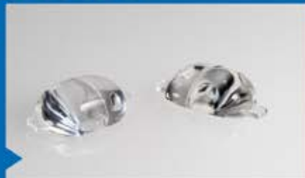
LL01CR-XW70140L02 L32 / W17.6 / H9.8 FWHM 70° x 140° For Cree XM-L Luxeon M -Symmetrical
