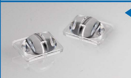
LL01CR-APM80150L02 L18 / W12.5 / H 6.95 FWHM 80° x150° For Cree XTE -Asymmetrical
